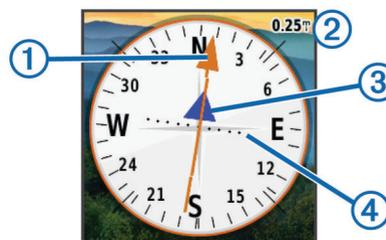
El puntero de trayecto ① indica tu relación con una línea de trayecto que conduce al destino. El indicador de desvío de trayecto (CDI) ③ proporciona la indicación de desvío (derecha o izquierda) del trayecto. La escala ② corresponde a la distancia existente entre los puntos ④ del indicador de desvío del trayecto, que te indica a cuánta distancia de desvío de trayecto estás.
