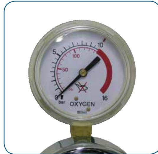
Indican presión a través de un sencillo mecanismo de fuelle y relojería. Los reguladores de presión normalmente cuentan con dos manómetros. Uno indica la presión de entrada del gas que viene del cilindro, y el otro, la presión de salida (presión de trabajo), que se puede regular con el tornillo o mariposa del regulador.
