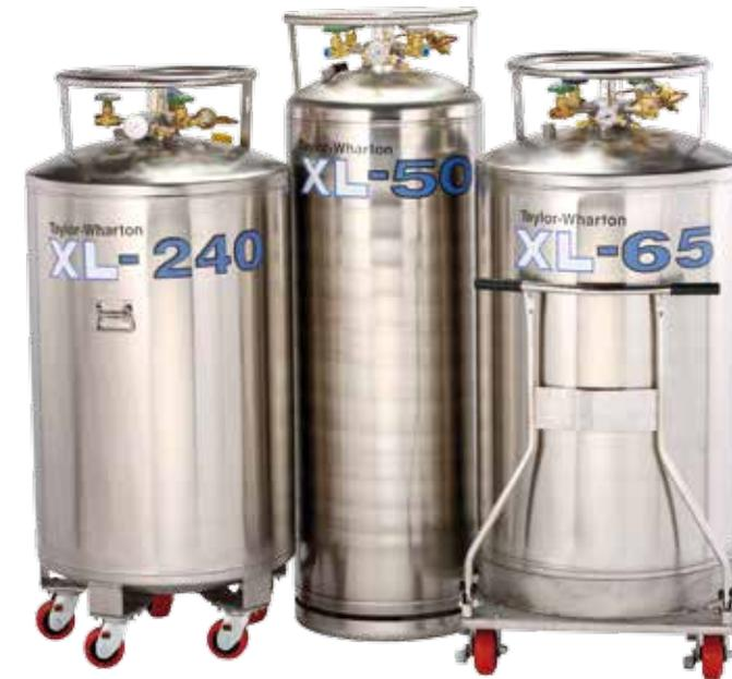
Son envases portátiles para líquidos criogénicos, fabricados de doble pared con aislación de alto vacío, y dispositivo de alivio de presión, que se usan para distribución de dióxido de carbono, oxígeno, nitrógeno y argón en estado líquido.
