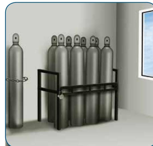
Un cilindro cuya válvula se rompiera, podría convertirse en un proyectil impulsado por la fuerza propulsora del gas, que sale a alta presión por un orificio de pequeño diámetro.
