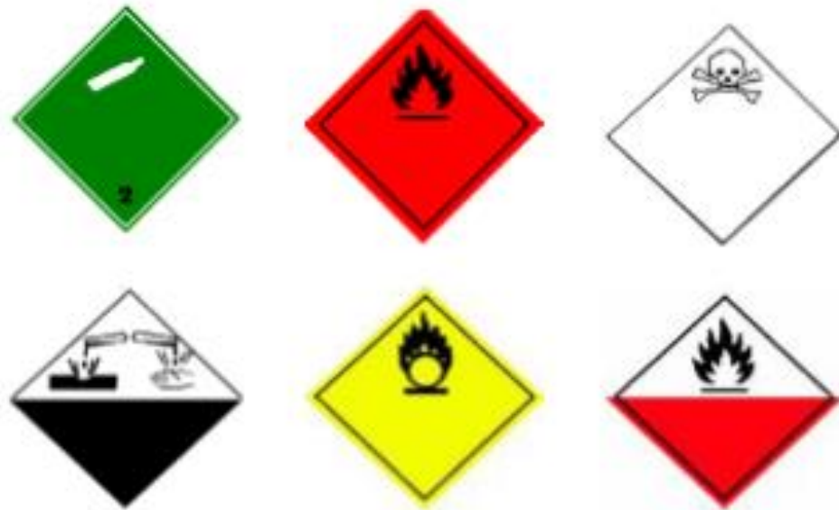
Figura 3. Etiquetes de perill per a gasos a pressió (gas no inflamable i no tòxic; matèria inflamable; matèria tòxica; matèria corrosiva; matèria comburent; matèria d'inflamació espontània).
