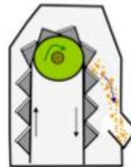
C- Descarga por gravedad a través cangilón escama.
